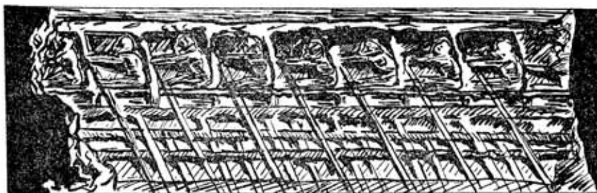
Fig. 1.—Trieria de la Acropolis de Atenas, siglo IV a. de J. C. en la que se ven claramente las tres filas de remos. Los «trhanitas» bogan entre los claros de la parte alta de las cuadernas de la superestructura. (Calco de un bajorrelieve)
