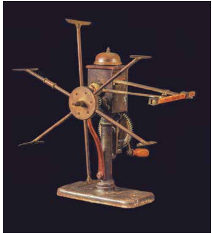
Hilatura de laboratorio utilizada en la Estación Sericícola para hilar seda
