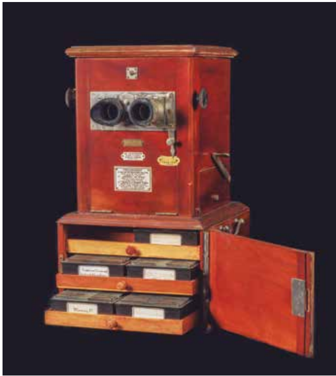
Velascopio. Aparato utilizado para visualizar negativos de fotografías
